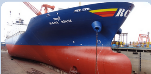
เรือ RCL ใช้สีกันเพรียงที่ปลอดสาร Cybutryne ซึ่งเป็นมลพิษต่อสิ่งแวดล้อมและสัตว์ทะเล
